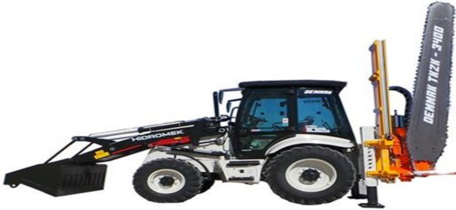
Şekil 10. Traktör kollu kesici (DEMMAK TKZK-3400 modeli) (İnt. Kyn 3, 2025)
