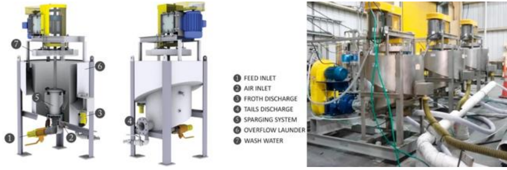
Şekil 10. Stack Hücresi (Mankosa, 2018)
