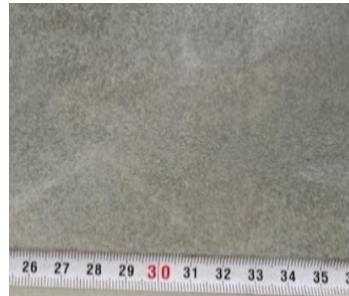
Şekil 9. TK-PN ell, Pünomatik Flotasyon Hücresi İçindeki Kabarcık Dağılımı
