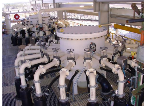
Şekil 5. Endüstriyel Ölçekli Jameson Flotasyon Hücresi (glencoretechnology.com)
