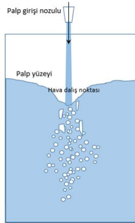
Şekil 7. Hava Sürüklenmesi (Air Entrainment) ve Kabarcık Oluşumu
