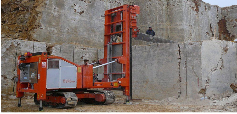
Şekil 9. Paletli Zincirli Kollu Kesici (Tataroğlu SVC 70 modeli) (İnt. Kyn 2, 2025)
