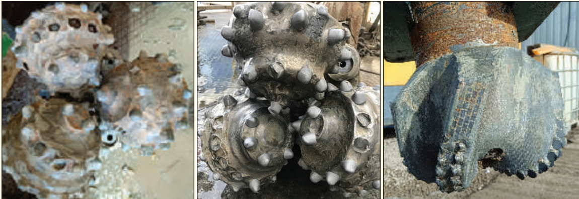
Şekil 4. 2 adet TCI ve 1 adet PDC matkabın sırasıyla kullanım sonrası durumu
