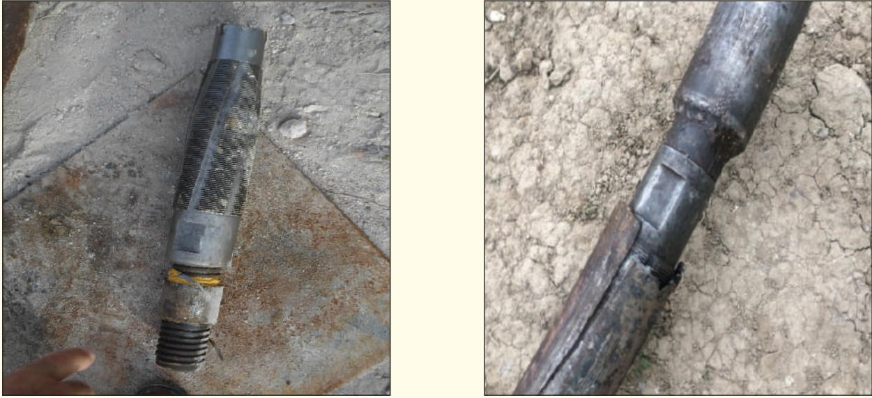
Şekil 2. Sağ erkek tahlisiye
