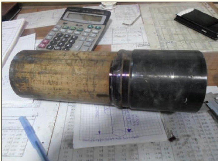
Şekil 13- PQ Uzatmadan yapılan HQ geçiş şapkası ve operasyonu
