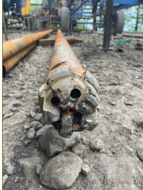
Şekil 11. Taramada kullanılan ve çaptan düşmüş olan 4 7/8" PDC matkap
