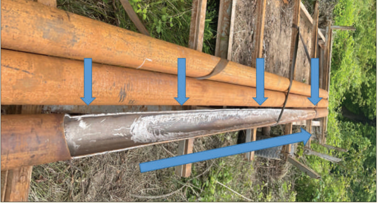
Şekil 10. HW muhafaza borusundan yapılan saptırma kaması
