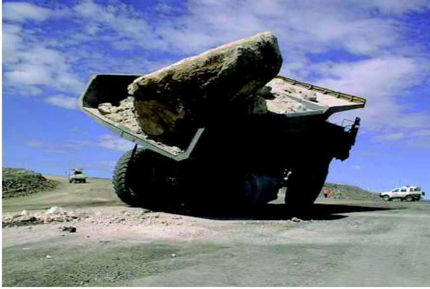
Şekil 2. Yerkazıda dengeli yükleme ve parça büyüklüğünün önemi (Wood 2009)
