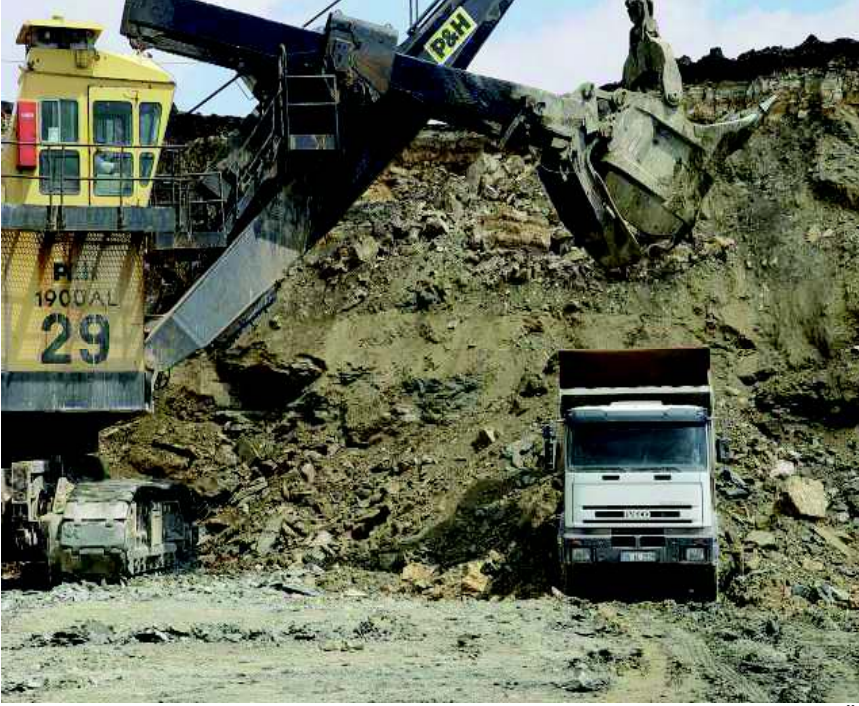
Şekil 1. Yerkazar kepçesi ve kamyon kapasitesi uyumsuzluğu (Özdoğan 2006)
