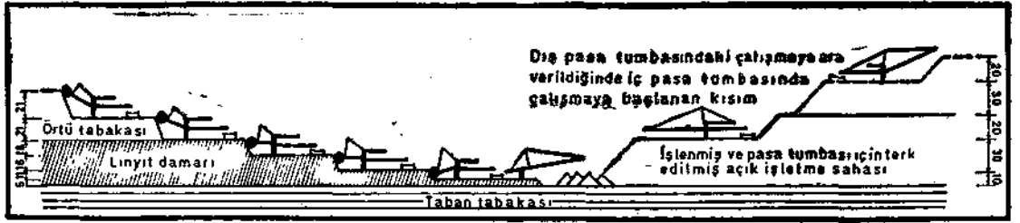
Açık işletmede başlıca makinaların çalışma düzenini gösterir kesit. Kesitte, hâzırda çalışan üç adet ve örtü tabakasında çalışan iki adet döner kepçeli ekskavatör ile üç adet örtü malzemesini yığma ve yayma makinası gösterilmiştir.
