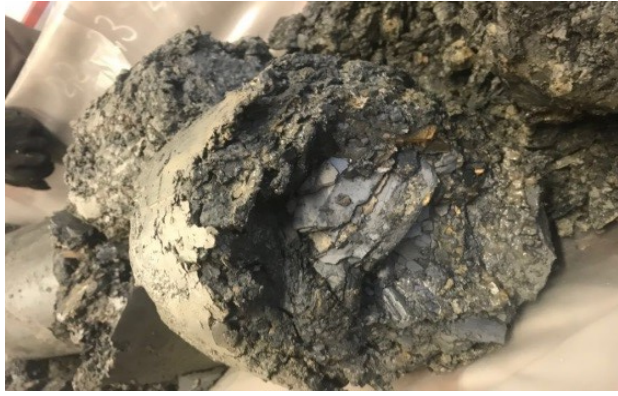
Şekil 5. Permafrost (donmuş zemin) örnekleme
