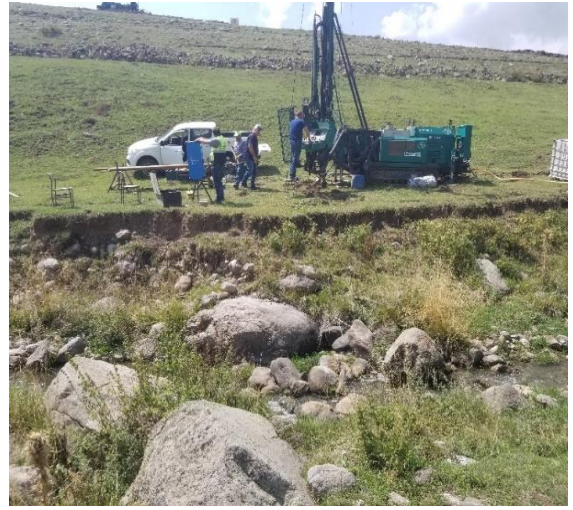
Erzurum Tortum Şenyurt Gölü Presiyometri Deneyleri
