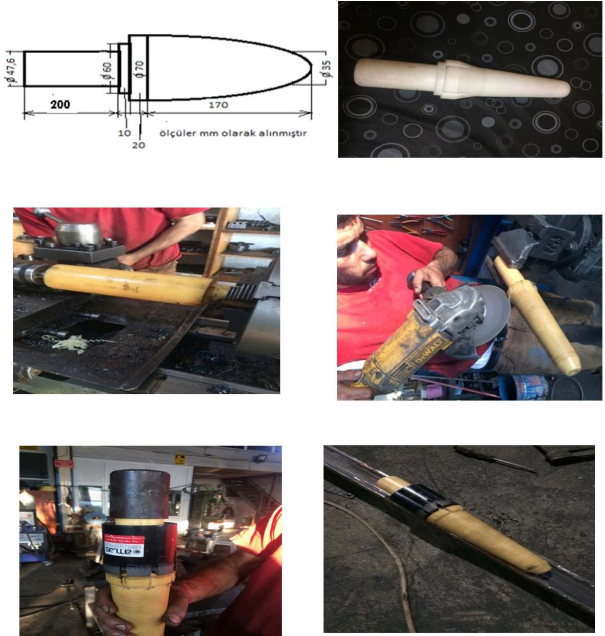
Şekil 8. Kestamit malzemeden matkabın ucuna ortalayışının hazırlanışı
