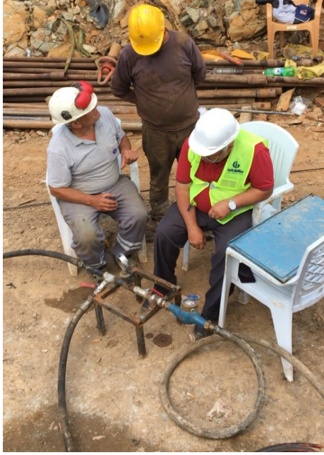
Şekil 8. BST deneyi sırasında manometre ve su sayacı okuma işlemi ve elde edilen sonuçlar (SK-4 kuyusu)
