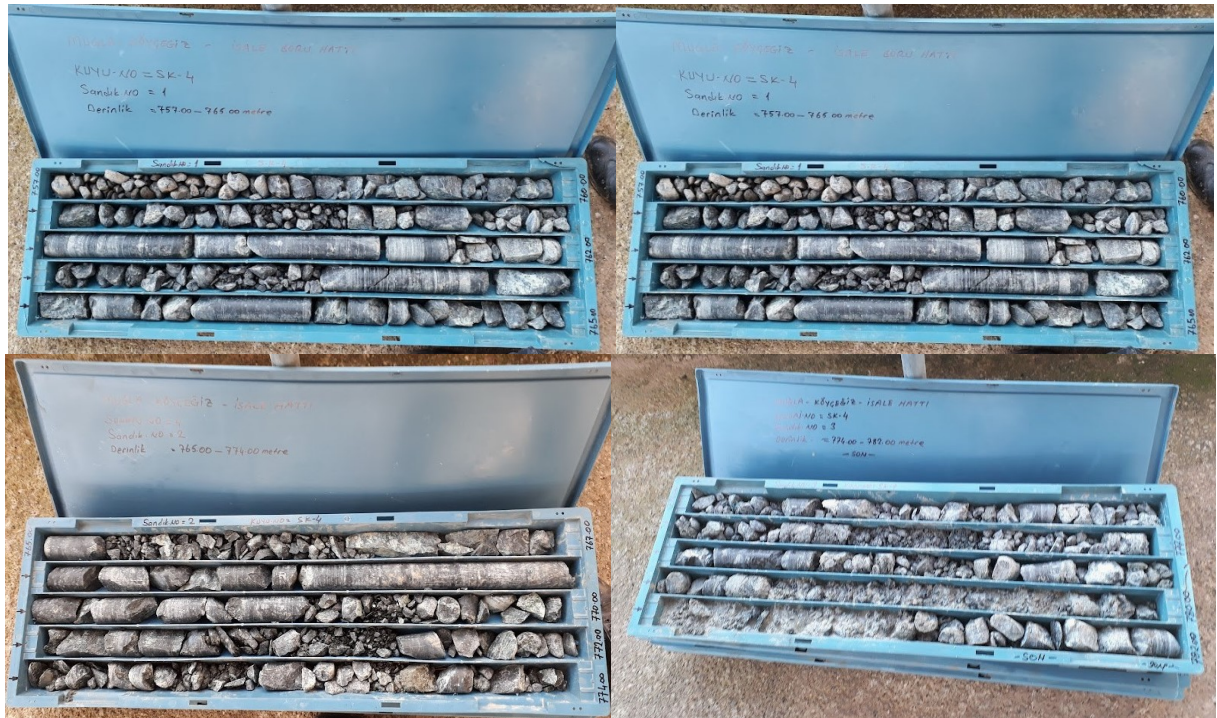
Şekil 6. SK-4 kuyusunda BST deneyi yapılan 757 - 782 m derinliklerinden alınan karotlar
