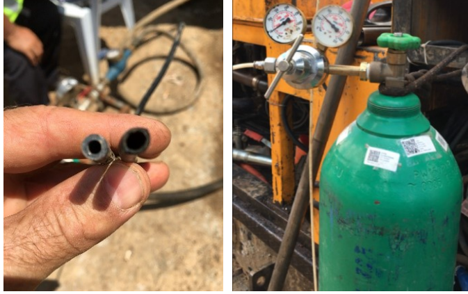
Şekil 9. Pakeri şişirmek için özel olarak imal edilen 120 bar basınca dayanıklı paker hortumu ve 150 bar basınçlı oksijen tüpü
