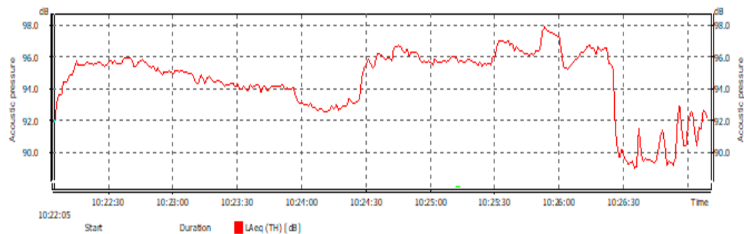
Şekil 6. Mavi kil formasyonundan çakıllı formasyona geçişte motor gürültüsündeki değişim.
