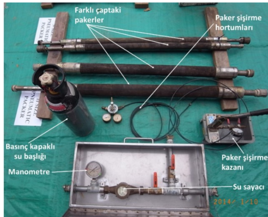
Şekil 1. Tek lastikli BST ekipmanları ve deneyin yapılışı
