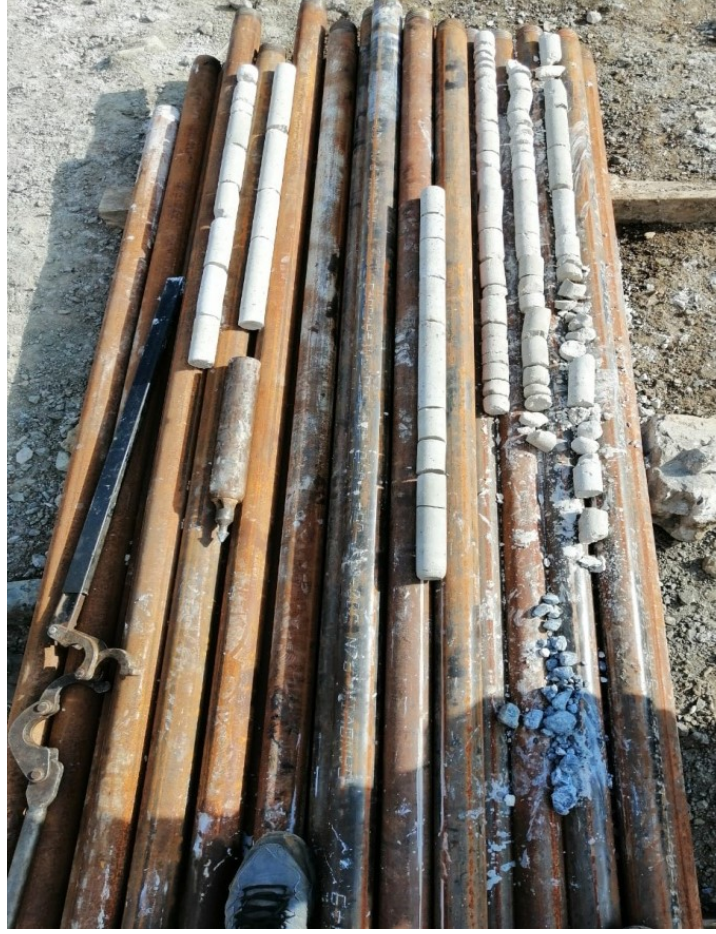
Şekil 5. Çimentonun priz alması beklendikten sonra kuyudan alınan çimento karotları
