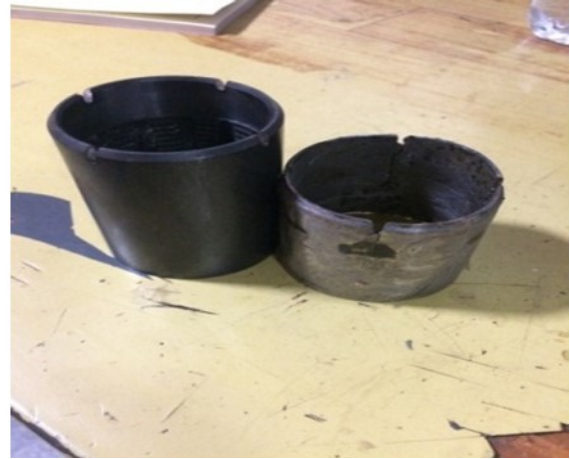
Şekil 3. 1. saptırma işlemi uygulanmasında, kuyudan çıkan elmas ve uzatma
