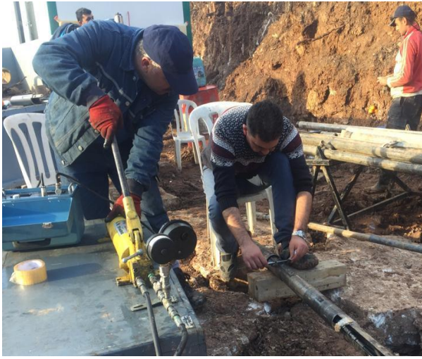
Antalya Eretepe Gölü Goodman Jack Dilatometre Deneyleri
