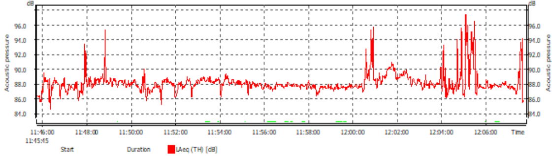
Şekil 11. Mavi kil formasyonunda ilerleme sırasında yaşanan problem ve ölçülen gürültüye ait spektrum.
