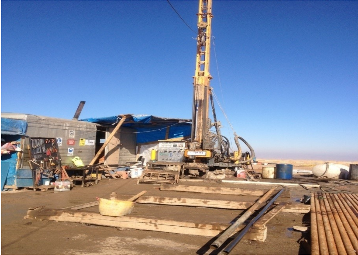
Şekil 11. 6 metrelik karotiyer ve iç tüp ile çalışma
