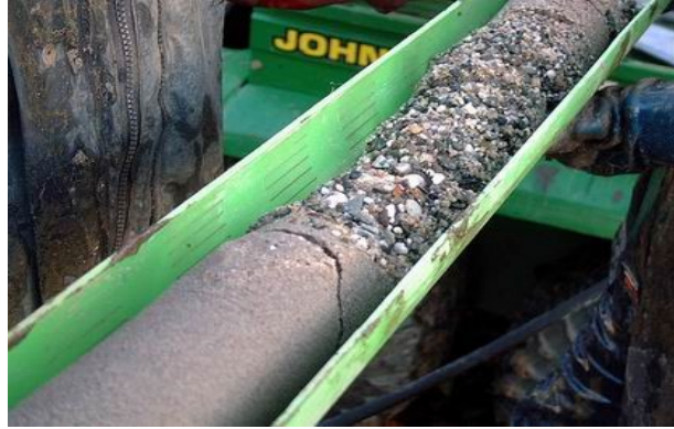
Şekil 2. Değişken alüvyonlardan alınan örnek
