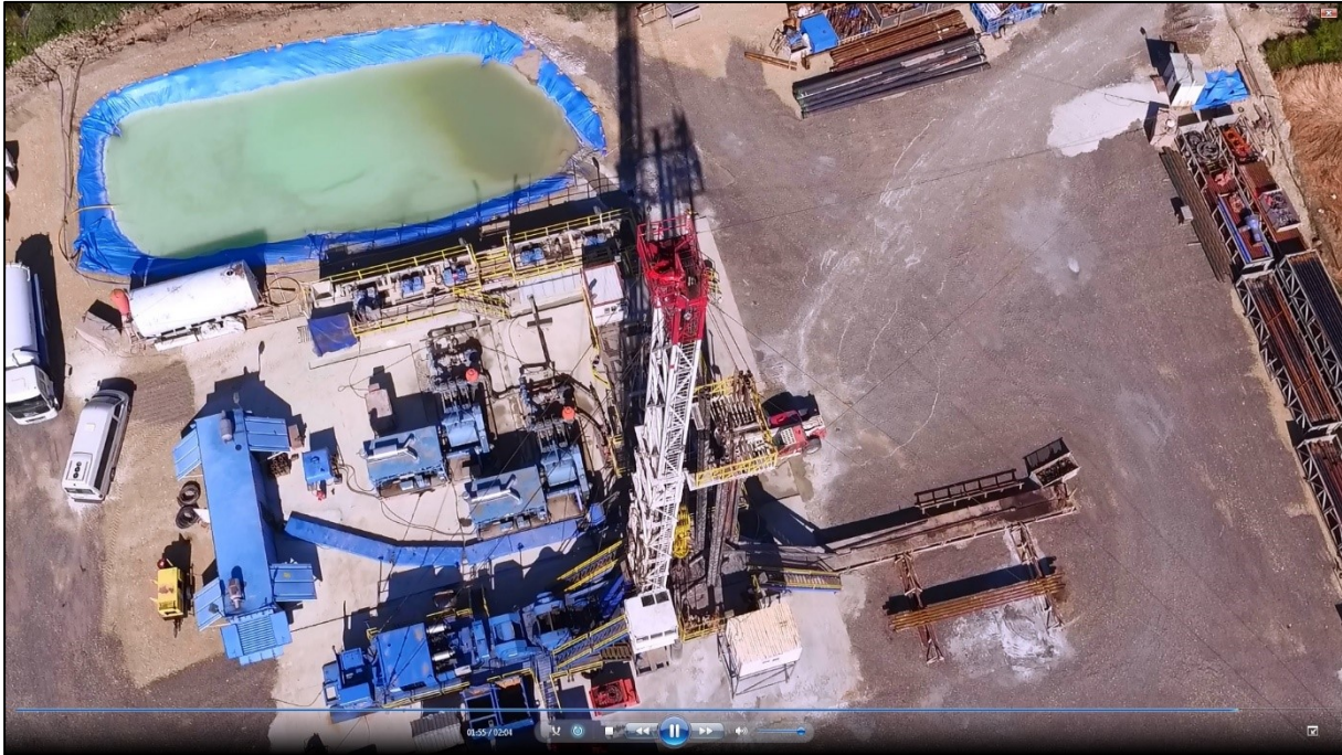
Şekil 3. Sondaj makinesi (NOV-750) ve ekipmanları
