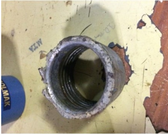
Şekil 3. 1. saptırma işlemi uygulanmasında, kuyudan çıkan elmas ve uzatma
