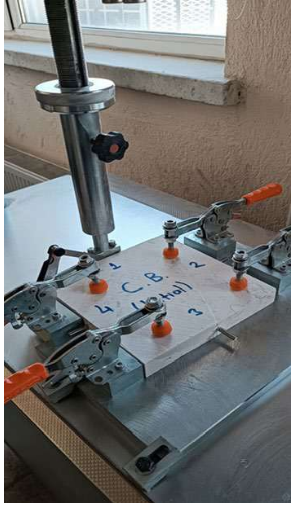
Şekil 5. Saplama deliğinde kırılma yükü tayini cihazında sabitlenen numune görünümü
