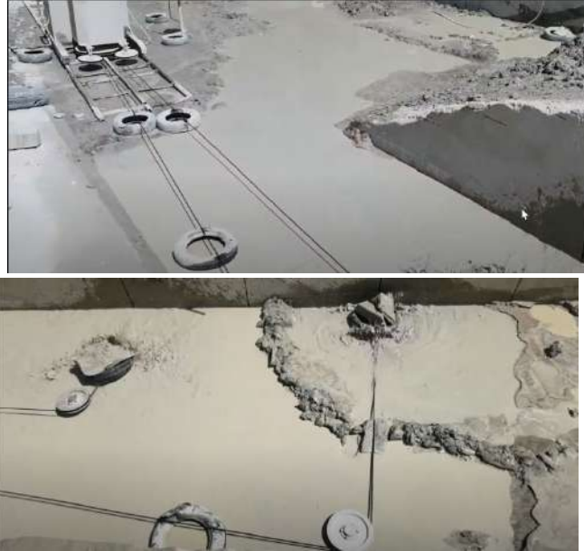
Resim 4. Mermer bloklarının hassas kesiminde modern tel ve makara sistemleri
