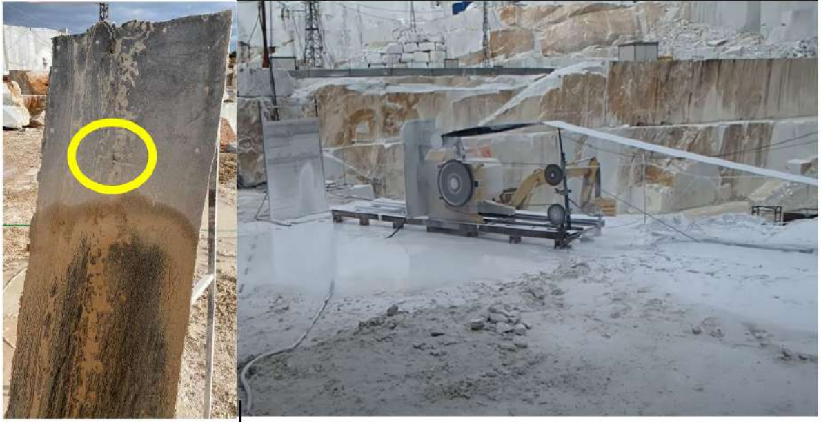
Resim 6. Elmas boncuğun koruyucu panoya saplandığı görüntü (sol), makine arkası koruyucu pano yerleşimi (sağ)
