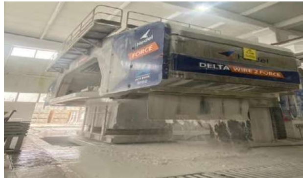
Şekil 2. Verilerin alındığı elmas telli katrak makinesi
