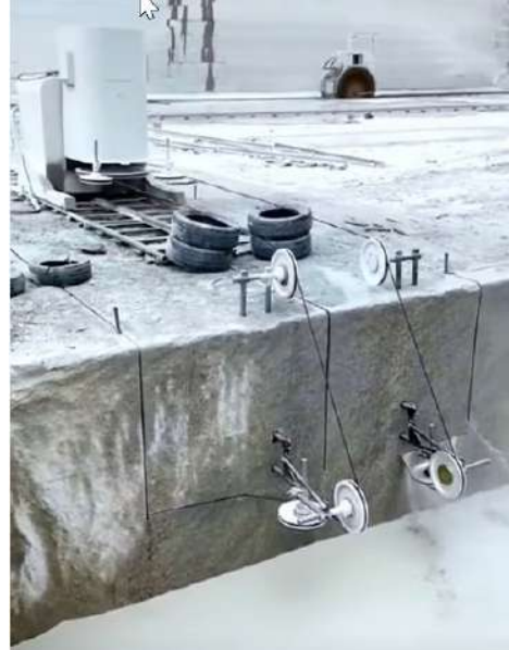
Resim 4. Mermer bloklarının hassas kesiminde modern tel ve makara sistemleri
