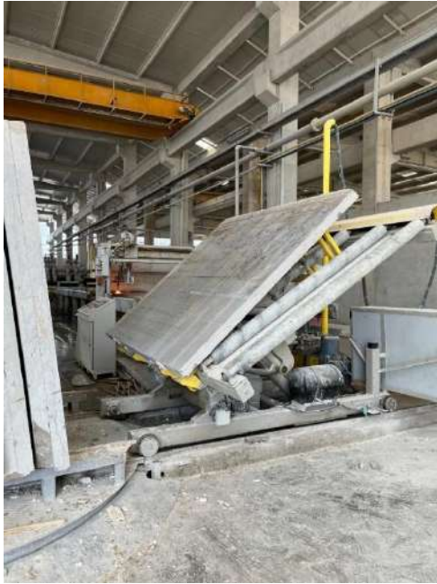
Şekil 3.a) Yükleme robotu plakayı alırken, b) Yükleme robotu plakayı masaya yerleştirdiğinde
