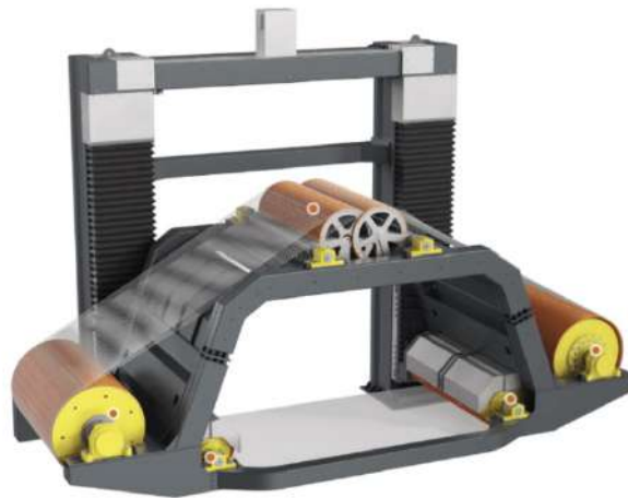
Şekil 1. Elmas Telle Kesim Yapan Ketrakların Çalışma Sistemi (Hedel, 2024)
