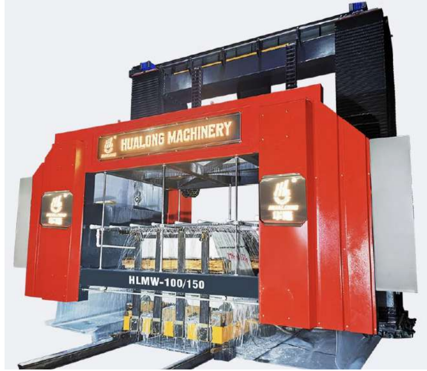
Şekil 5. Vakumla lehimlenmiş ince telle kesim yapan katarak. (İnt. Kayn.1)
